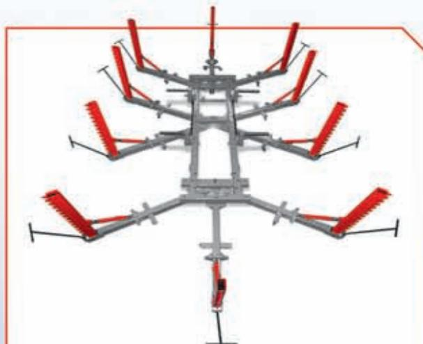
Рама стапеля дает 28 вариантов установки силовых устройств в разных участках по периметру рамы, создавая рабочую зону в 360°. Параллельный вариант установки силовых устройств позволяет увеличить усилие вдвое. Например, для вытяжки лонжеронов.
